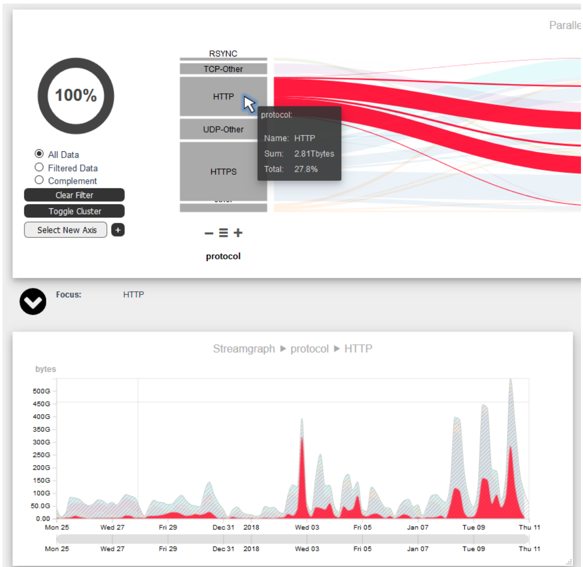
Abbildung 5.14.: Highlighting zwischen den Ebenen. Da die Maus in der zweiten Ebene auf HTTP zeigt, wird im Streamgraph HTTP gehighlightet und zusätzlich als unterste Kategorie angezeigt. Dadurch kann die Höhe der Peaks besser bestimmt werden.
