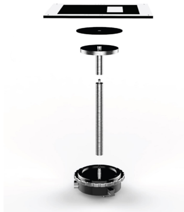
Abbildung 5.2: Konzeptmodell Markeradapter [Jer16]
