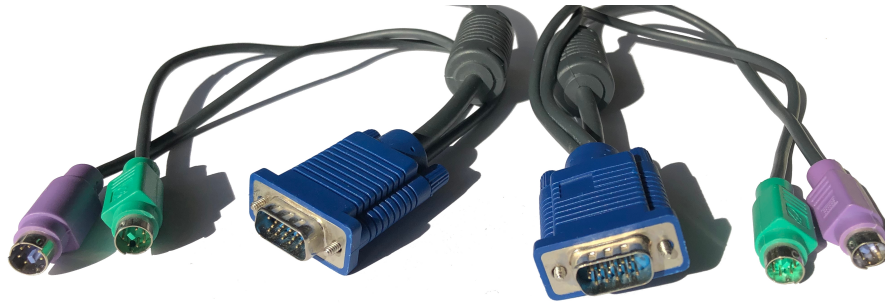
Abbildung 2.4: Kombiniertes Kabel für den Anschluss von Tastatur, Bildschirm und Maus. Ausführung für die Verwendung zwischen Computer und KVM-Umschalter.
