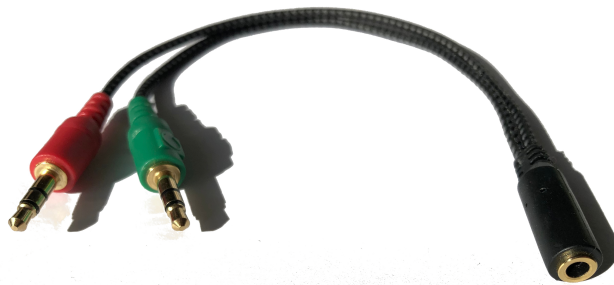
Abbildung 2.5: Adapterkabel, welches die Audiosignale der Anschlüsse für Stereo-Audio und Mikrofon zu einem kombinierten Anschluss für Audio und Mikrofon zusammenführt.
