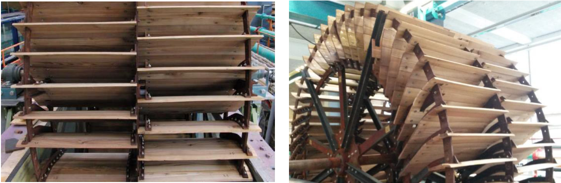
Abbildung 34 Halbe Schaufelteilung: links – Ansicht entgegen der Strömungsrichtung, rechts – Gesamtansicht
