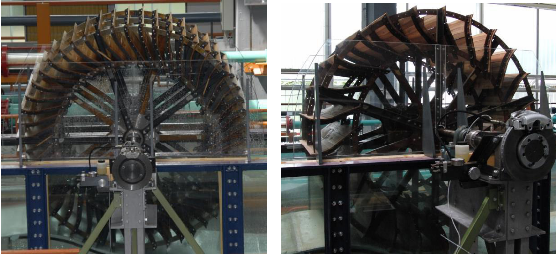
Abbildung 60 Variation der Schaufelanzahl: links – Wasserrad mit 50 Schaufeln, rechts – Wasserrad mit 25 Schaufeln
