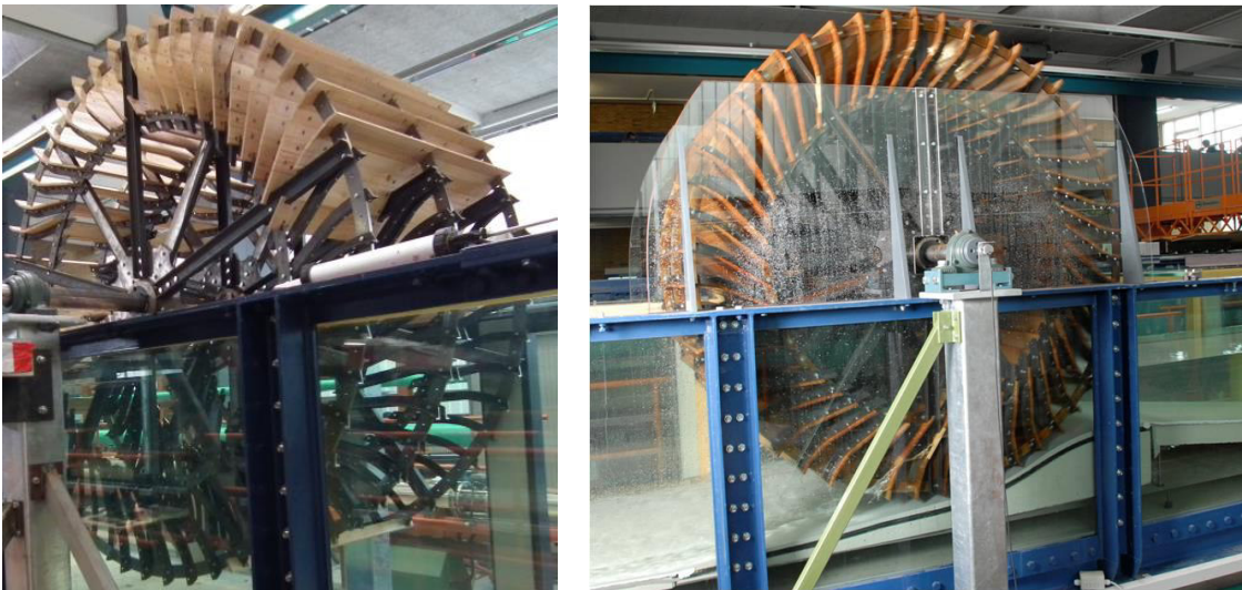
Abbildung 23 Wasserrad des Versuchsstandes: links - Aufbau des Modell-Wasserrades, rechts - Seitenansicht des Modell-Wasserrades im Endzustand
