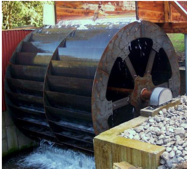
Abbildung 33 Oberschlächtiges Wasserrad mit Zellenteilung (Firma Schuhmann, Bad Kissingen)
