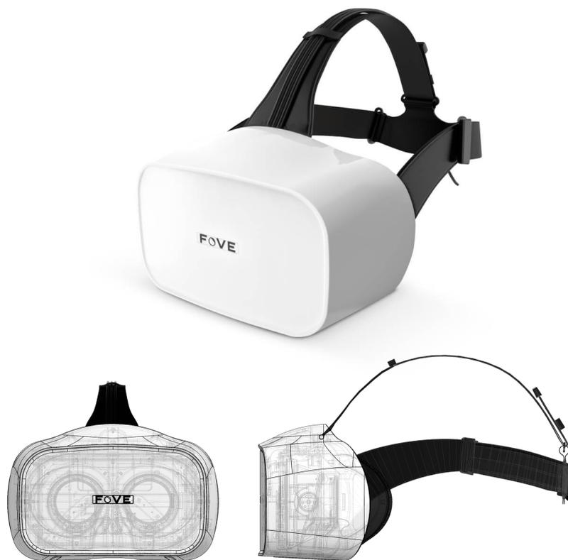
**Abbildung 3.1:** Oben: Ein Bild des FOVE VR HMD, welche über integriertes Eye Tracking verfügt. Unten: technische Zeichnungen des FOVE. Zu erkennen sind die eingebauten Linsen. Quelle: <https://www.getfove.com/> (zuletzt besucht am 12/16/2018).
