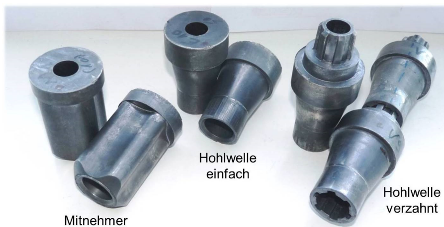
Abbildung 56: Im Rahmen der Formgebungsversuche erzeugte Musterwerkstücke zur Bewertung der betrachteten Prozessroute für das Thixo-Schmieden von Rohrhälbzeugen
