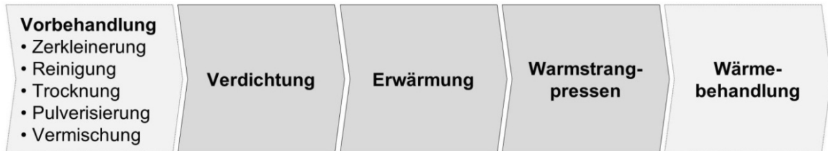
Abbildung 21: Prozesskette zur Herstellung von Strangpressprofilen aus recycelten Metallspänen mittels Warmstrangpressen
