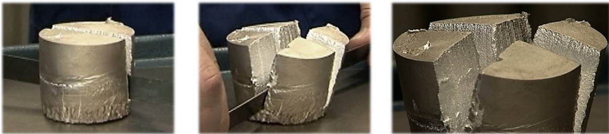
Abbildung 1: Schneidversuch an einem in den Temperaturbereich zwischen Solidus- und Liquiduslinie erwärmten zylindrischen Rohteil aus AlSi7Mg0,3 (Flüssigphase ca. 50 %) [IFU10]
