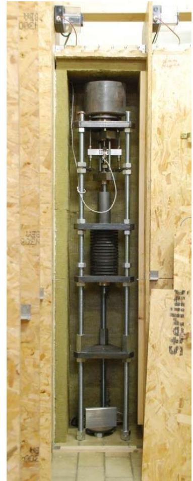
**Abbildung 4.10:** Wärmekammer für Einzelversuche
