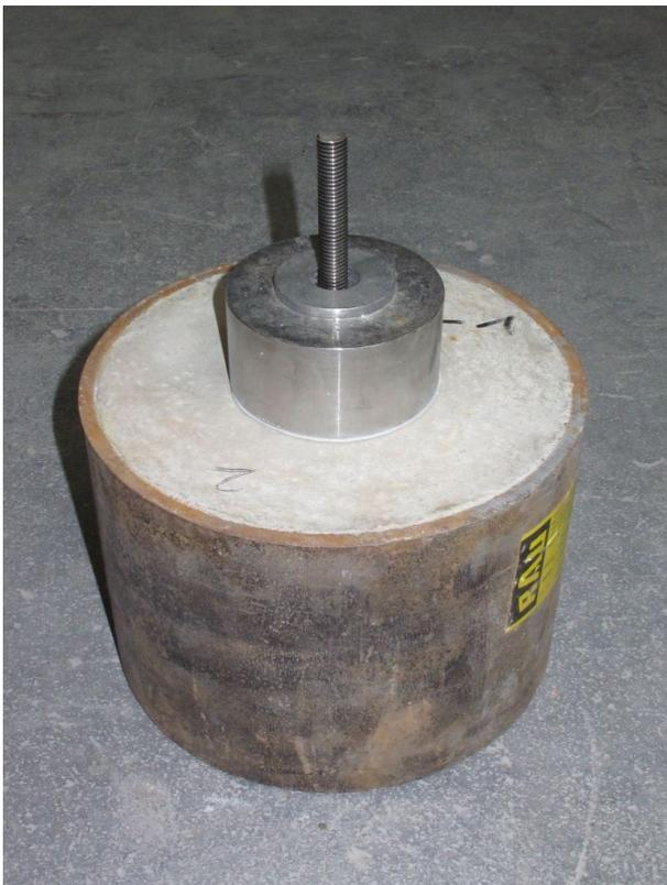
**Abbildung 5.1:** Versuchskörper aus Beton in Form eines ausbetonierten Stahlrings (hier mit installiertem Dübel und Druckplatte)
