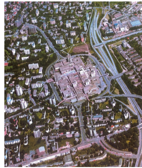
Abb. 2.16 Das multifunktionale Zentrum von Frankfurt-Nordweststadt Landfläche 700 ha Urbane Nutzungsfläche 9,5 ha Für gesellschaftliche Kommunikation 2,6 ha Anlieferstraßen und Parkflächen 9,3 ha
