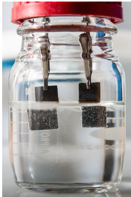
Abbildung 2.20: Elektrokatalytische Zersetzung von Wasser unter Bildung von Wasserstoff und Sauerstoff. Entnommen aus Referenz [127]
