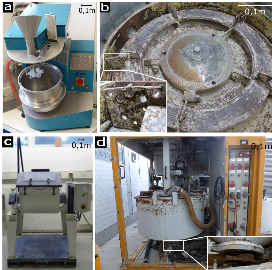
Abbildung 2.3.: a) Laborintensivmischer mit Stiftwirbler, b) Mischzelle des Suspensionsmischers SC-50-K mit perforiertem Blattrührer, c) Einwellenmischer, d) Suspensionsmischanlage OM 800 mit geöffneter Mischzelle
