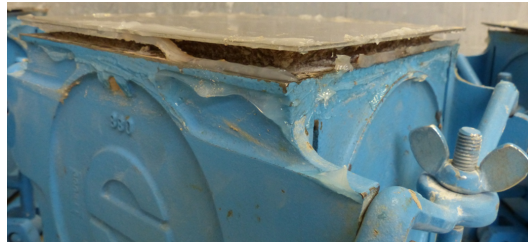
Abbildung 6.7.: Quellen der Probekörper infolge Wärmebehandlung (40 °C) zur Beschleunigung des Erstarrens
