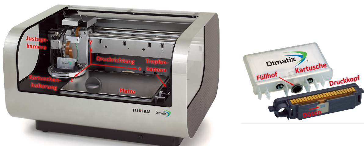
Abbildung 2.3 – (Links) FujiFilm Dimatix DMP-2831 Materials Printer. (Rechts) Kartusche mit Druckkopf. Mit freundlicher Genehmigung von FujiFilm Dimatix Inc. (Santa Clara, Cal., U.S.A.)
