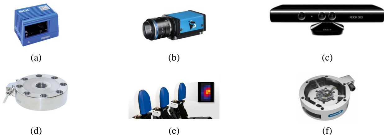
Abbildung 2-6: Gebräuchliche Sensoren zur exterozeptiven Perzeption: 2D-Laserscanner [123] (a); RGB-Kamera [124] (b); RGBD-Kamera [125] (c); Zug-Druck-Kraftsensor [126] (d); Taktile Sensormatrix [127] (e); 6D-Kraft-Momentensensor [128] (f)
