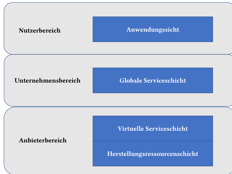
Abbildung 2.4.: Vierschichtenarchitektur für eine Cloud Manufacturing Service Plattform nach Xu [Xu12]
