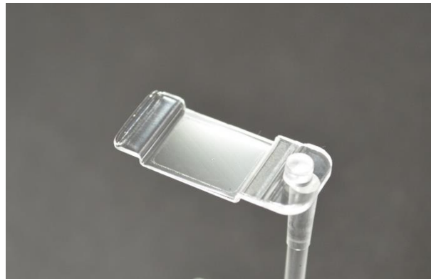
Abb. 5-20: Spritzgeprägtes MLA, bevor der Anguss entfernt wurde [32]
