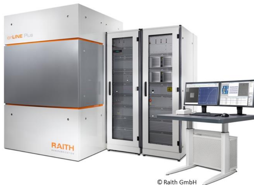
Abb. 7-6: ionLINE Plus Ionenstrahlschreiber der Fa. Raith GmbH zur Herstellung von nanostrukturierten Werkzeugeinsätzen
