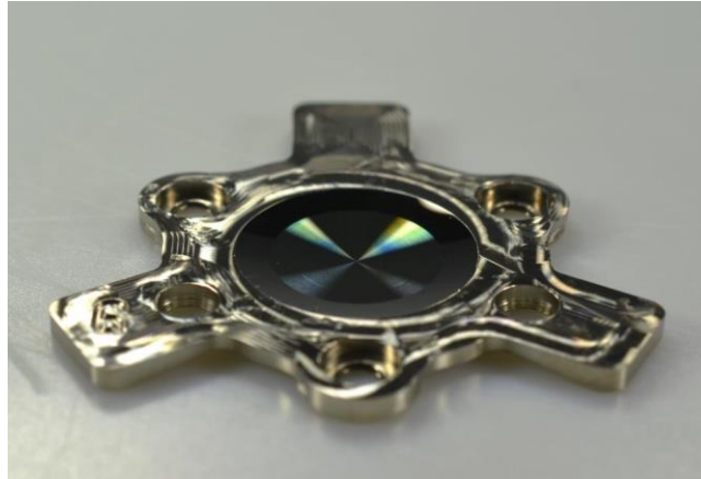
Abb. 3-11: Mittels Galvanokopieren abgeformter Werkzeugeinsatz von einem durch LDW hergestellten Mastersubstrat [63]
