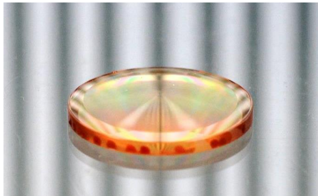
Abb. 3-12: Gekrümmter Glasmaster mit diffraktiver Struktur, hergestellt mittels LDW [63]
