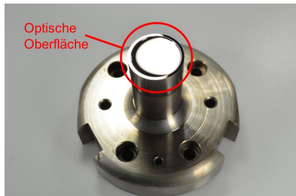
Abb. 3-6: Diamantgedrehter Werkzeugeinsatz mit asphärischer Form ( R_a = 6 \text{ nm} )
