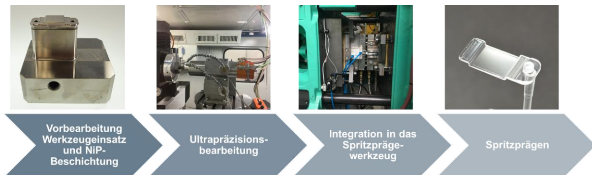
Abb. 5-2: Prozesskette zur Herstellung von MLAs mittels Ultrapräzisionsbearbeitung und Spritzprägen
