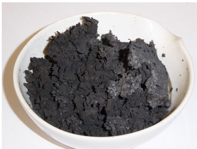
Abbildung 5.1: Trägermaterial La-Co-O nach der Kalzinierung.
