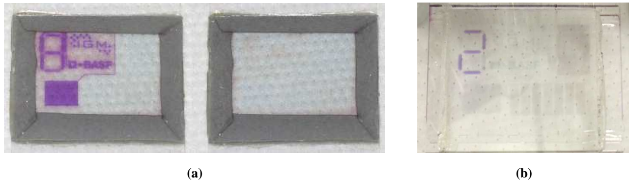
Abbildung 5.2 – Elektrochrome Siebensegmentanzeige auf Basis des traditionellen Zellbauprozesses. Die Testzelle besteht in (a) aus strukturierten ITO-Elektroden, einer ganzflächigen per Spraycoating aufgetragenen Schicht des elektrochromen Materials und wurde mit Klebeband versiegelt. Links ist der reduzierte Zustand und rechts der oxidierte Zustand der Teststrukturen (Siebensegment, Logos, Rechteck) sichtbar. Die Anzeige in (b) besitzt sowohl eine strukturierte ITO-Elektrode als auch eine strukturierte ECP-Schicht, verwendet Kugelspacern als Abstandshalter und wurde mit Klebstoff versiegelt. Die Siebensegmente für eine zwei sind reduziert, alle anderen Elemente (leicht gräulich) sind oxidiert und damit transparent.
