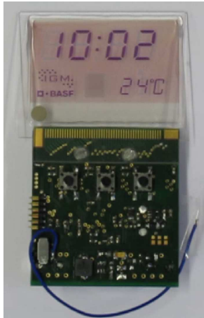
Abbildung 7.1 – Demonstrator für segmentierte elektrochrome Anzeigen im Betriebsmodus Uhr.
