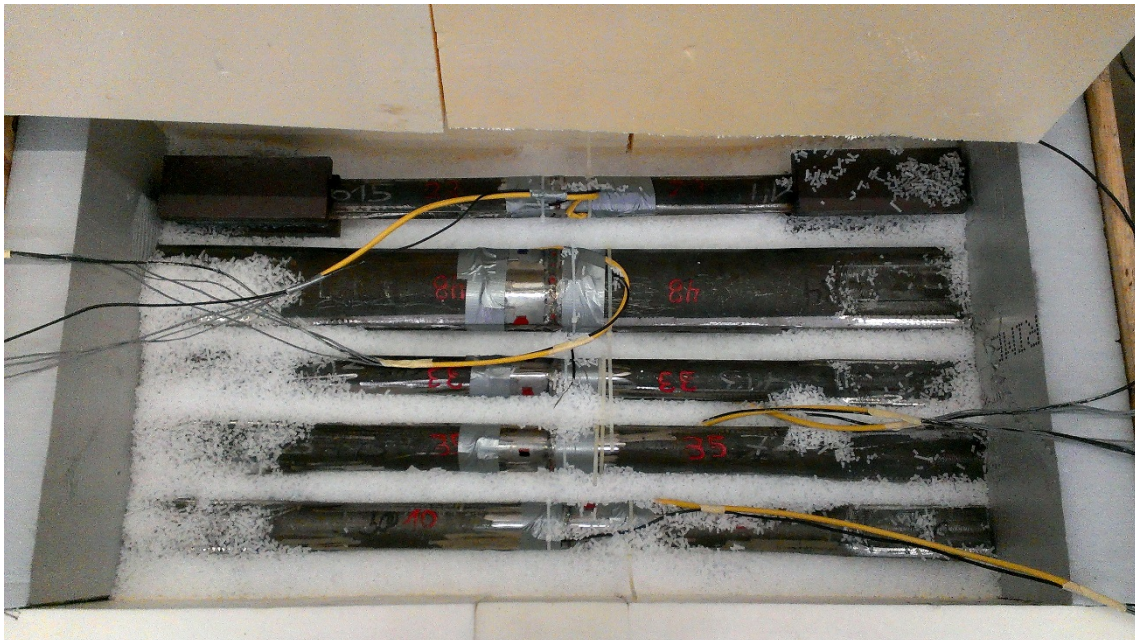
Abb. 7-3: In Trockeneis eingelegte Prüfkörper in der Thermobox mit applizierter Messtechnik
