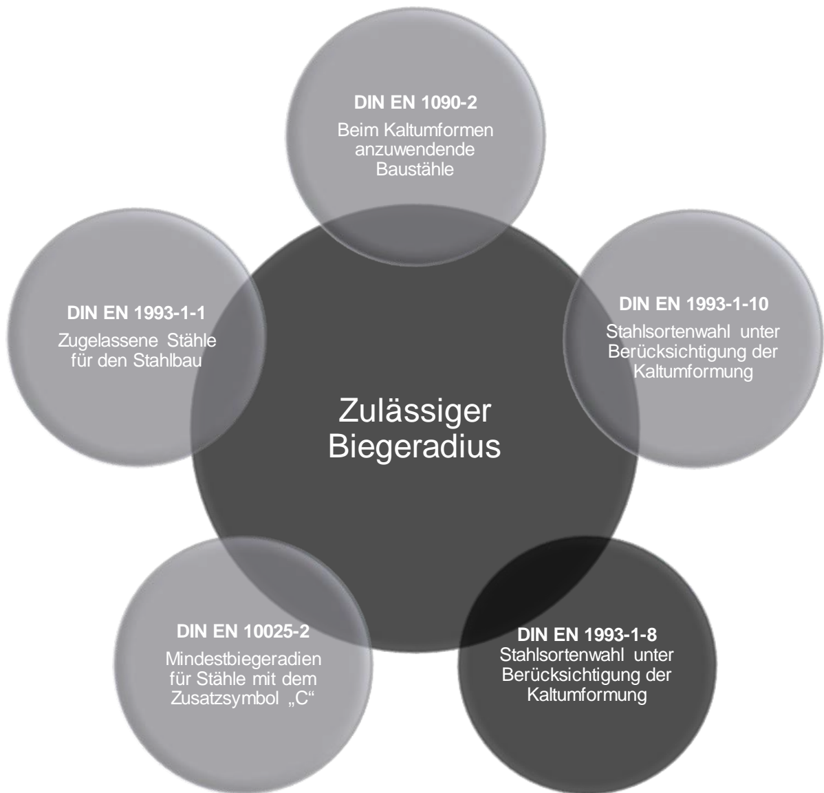
Abb. 2-61: Regelwerke und deren Einfluss, durch die der zulässige Biegeradius an Bauteilen bestimmt wird, bei denen im kaltumgeformten Bereich geschweißt werden darf.
