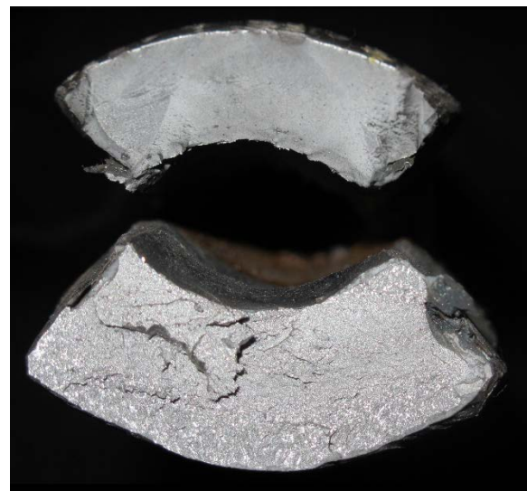
b) Pk. 42, Sprödes Bruchverhalten, beide Halbschalen zeigen eine glatte Bruchfläche
