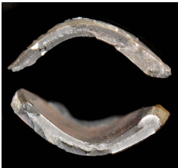
a) Pk. 34, Duktiles Bruchverhalten, beide Halbschalen weisen Scherlippen auf.
