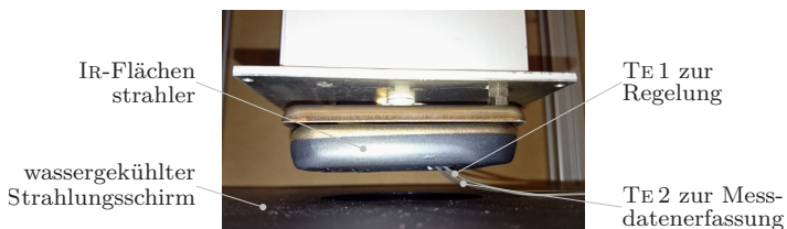
Abbildung A.1: Thermoelemente zur Leistungsregelung und -messung am DTV
