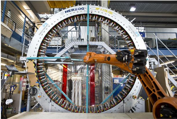
Abbildung 5: Radialflechtmaschine Herzog RF-1-176-100
