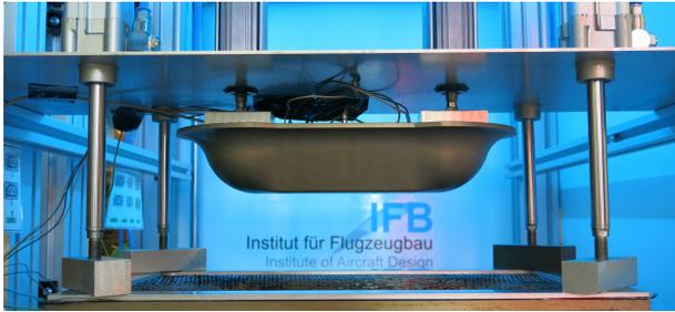
Abbildung 16: Einteiliges Stempelverfahren mit einer Double-Dome Geometrie.
