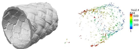
Abbildung 31: Mittels  $\mu$ CT rekonstruierte Faserarchitektur und Poren (rechts) eines Geflechtzylinders aus [100]
