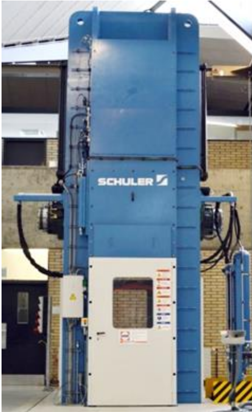
Abbildung 6.5: Links: Servomechanische Presse am Institut für Umformtechnik; Rechts: Einbauraum der Presse mit Versuchswerkzeug
