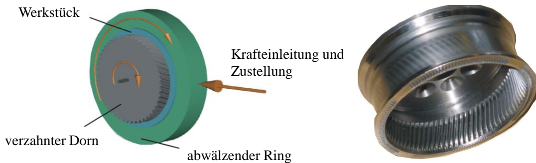
Abbildung 2.6: Links: Drückwalzen nach dem Ring-Prinzip; Rechts: Laufrad mit Innenverzahnung
