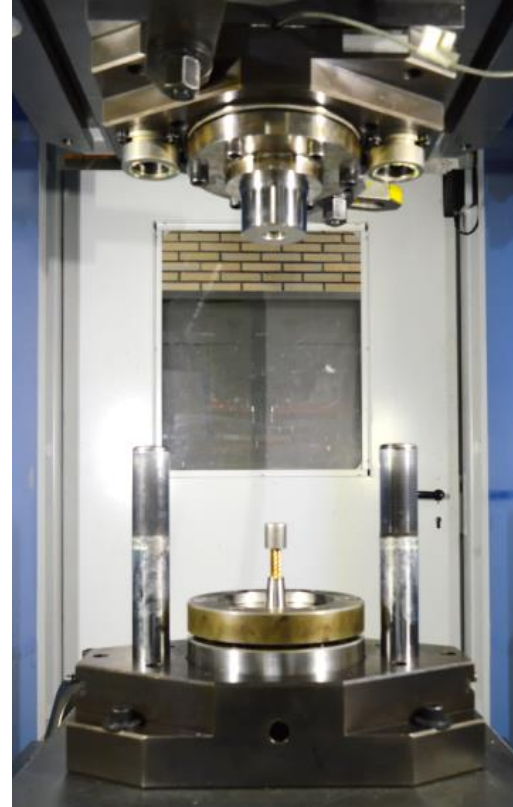
Abbildung 6.5: Links: Servomechanische Presse am Institut für Umformtechnik; Rechts: Einbauraum der Presse mit Versuchswerkzeug
