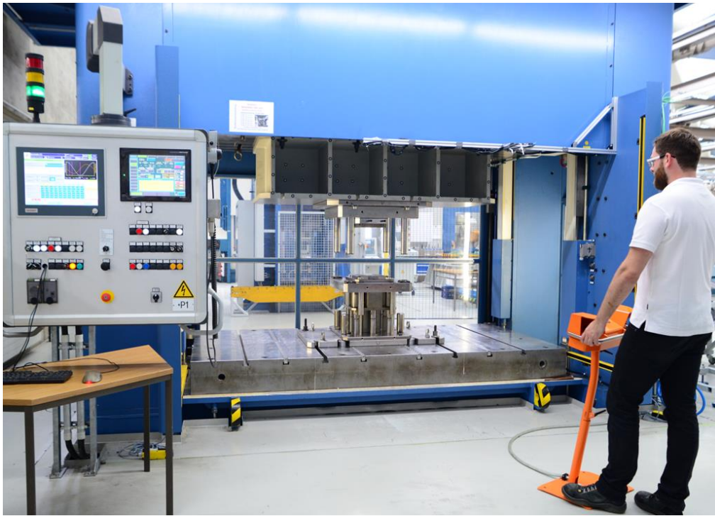
Abbildung 49: AIDA Servo-Pressen mit eingebautem Ziehwerkzeug „Rechtecknapf“
