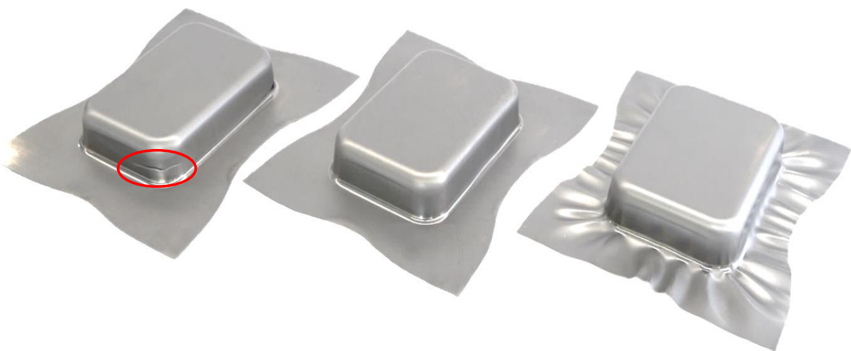
Abbildung 5: Mögliche Fehler beim Tiefziehen: Reißen (rot), Gutteil, Faltenbildung 1. Art (von links)
