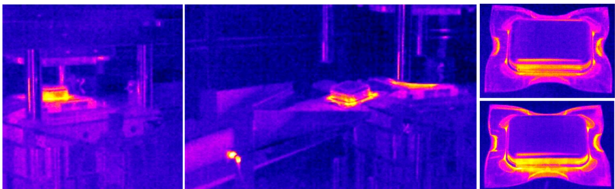
Abbildung 62: Aufnahmen der Wärmebildkamera während des Pressvorgangs (links und mittig), „Rechtecknapf“ nach 10 Hüben (rechts oben) und 80 Hüben (rechts unten)
