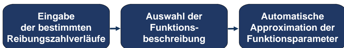
Abbildung 84: Vorgehensweise zur Approximation der Funktionsparameter mittels des Open-Source-Codes nach [Phi17]
