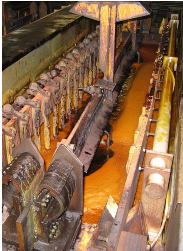
Abb. 1: Hartchrombad mit 250 g/l Chromsäure + einem F-haltigen Netzmittel
