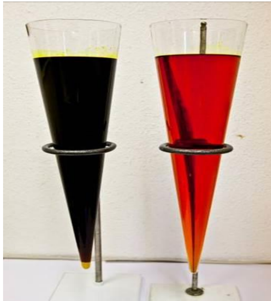
Abb. 7: Chromsäure, vor und nach der Reinigung, Beispiel 2
