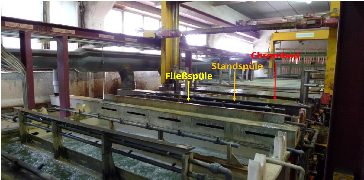
Abb. 2: Teil einer Straße des Galvanoautomaten, der die Verchromung enthält
