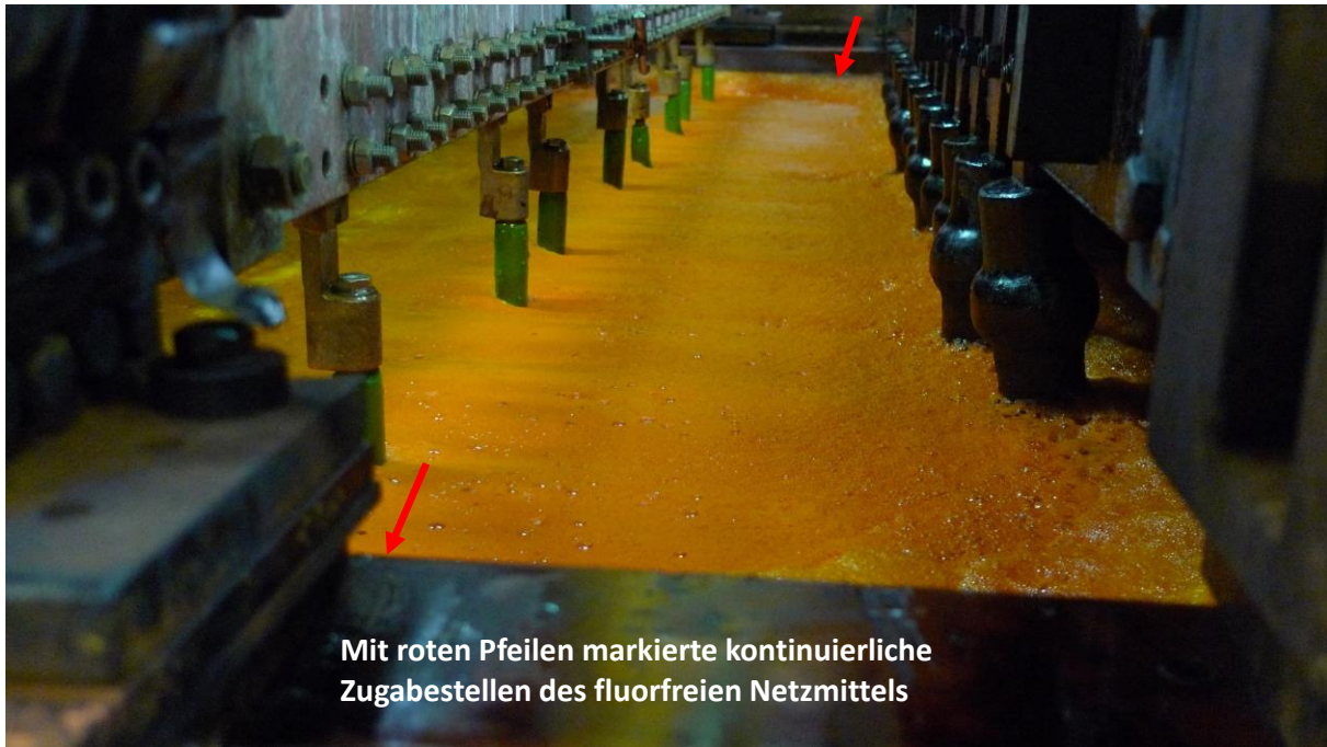
Abb.5: Chrombad mit stabiler Schaumschicht mit Andeutung der beiden Zugabestellen des fluorfreien Netzmittels
