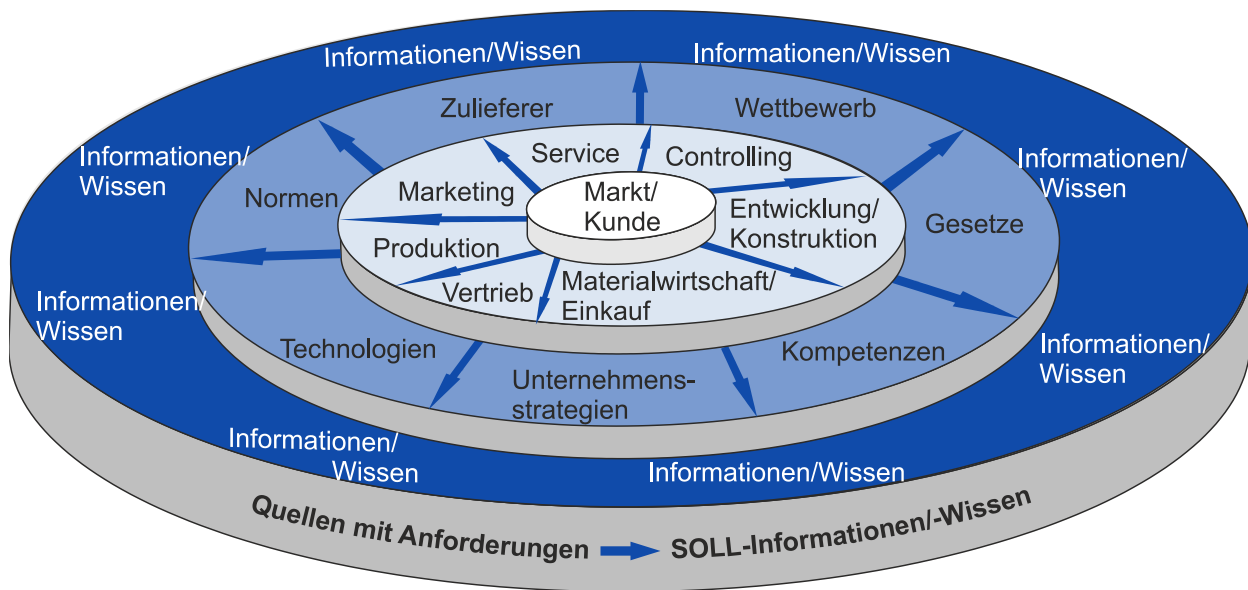
Bild 5.10: Quellen für Anforderungen nach [LINDEMANN09, S. 97] – erweitert um Informations-/Wissensebene
