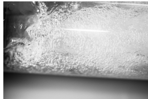
Abbildung 6.1: Schematische Darstellung eines FSA mit Einteilung der Funktionsbereiche (Treibleitung - blau; Saugleitung - gelb; Blasenströmung - grün, links); Entstehung der Blasenströmung im Bereich der Fangdüse durch Aufreißen des Treibstrahles in einem transparenten FSA (Technikums-Teststand HL 500 bei \dot{V}_{SA,g} = 10 \text{ m}^3/\text{h} , \varphi_g = 0,87 , rechts).
