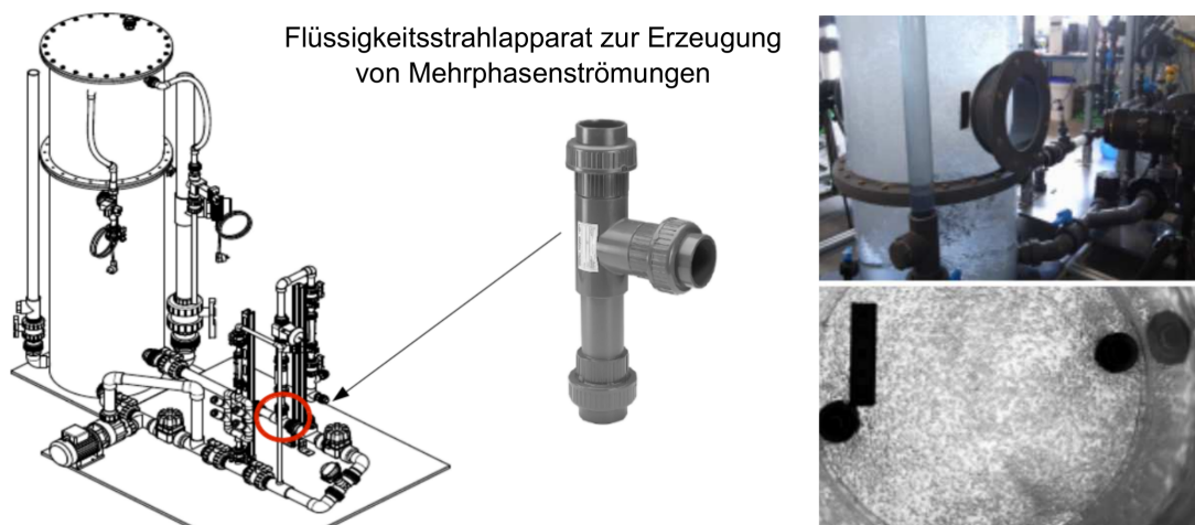
Abbildung A.1: CAD-Zeichnung des Teststandes mit Darstellung der Einbauposition des Flüssigkeitsstrahlapparates (links) und Fotografie der Blasenströmung am Schauglas des Flotationsbehälters (rechts)
