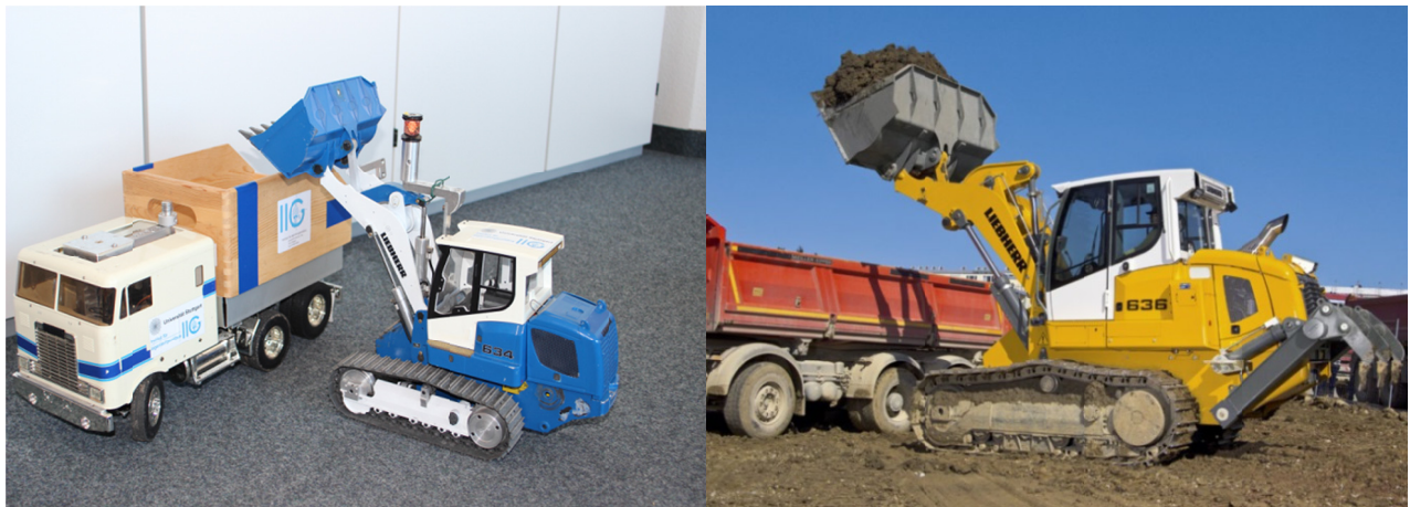
Abbildung 6-22: links: Modell LR 634, Masstab 1:14; rechts: reale Maschine LR 636 (Liebherr 2019)
