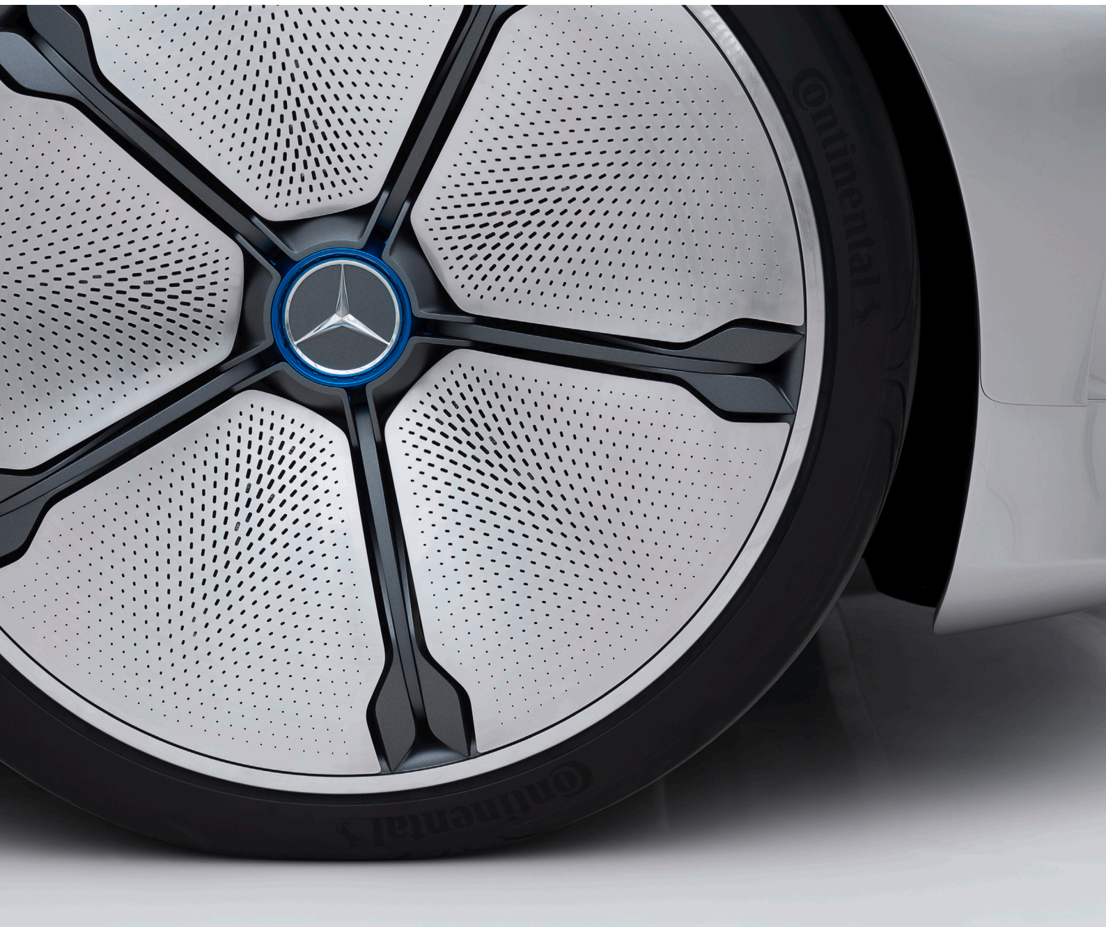
Abb. 43: Nahaufnahme des algorithmisch generierten Perforationsmusters zur Belüftung der Bremsanlage. (Quelle: Mercedes-Benz)
