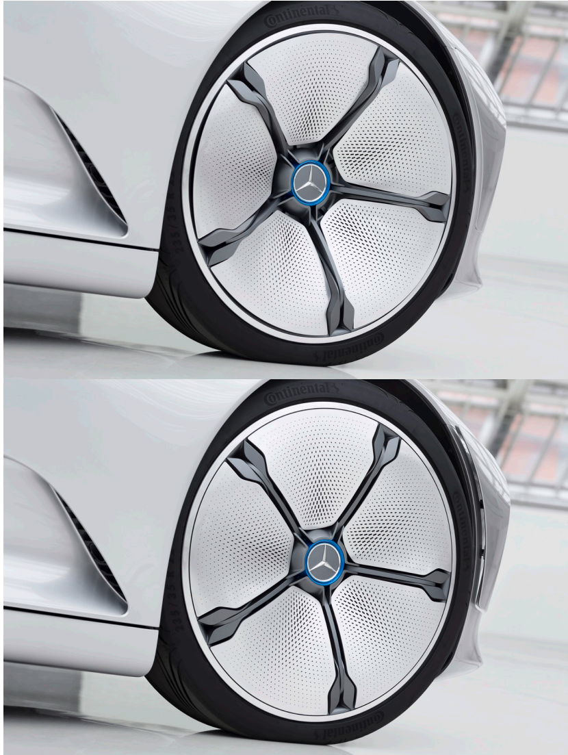
Abb. 42: Aerodynamikfelgen mit passiver Kinematik: (oben) Zustand mit dynamischer Schüsselung; (unten) Aerodynamischer Zustand mit Ähnlichkeiten eines Scheibenrades. (Quelle: Mercedes-Benz)
