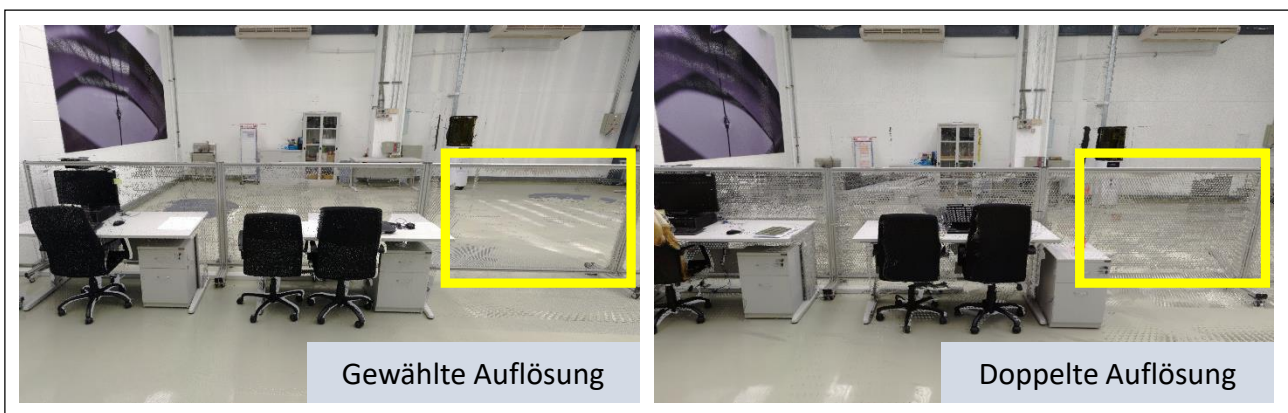
Abbildung 6-6: Aufnahme desselben Raums mit der gewählten Auflösung von 0,04^\circ Winkelunterschied (links) und der doppelten Auflösung
