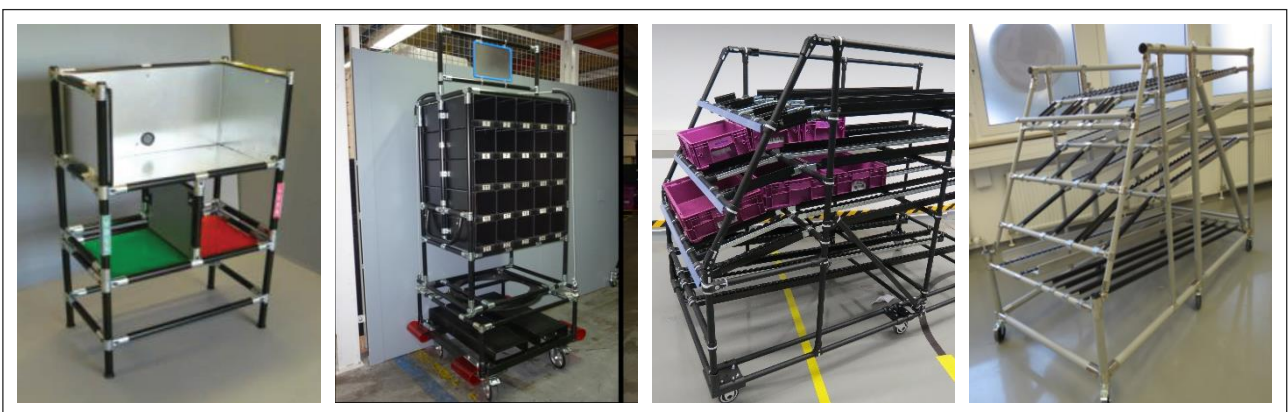
Abbildung 3-5: Betriebsmittel, die vor Ort – ohne digitale Konstruktion – erstellt wurden
