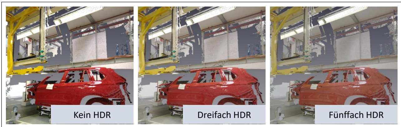
Abbildung 6-8: Qualität der Punktwolke bei unterschiedlichen HDR-Foto-Einstellungen
