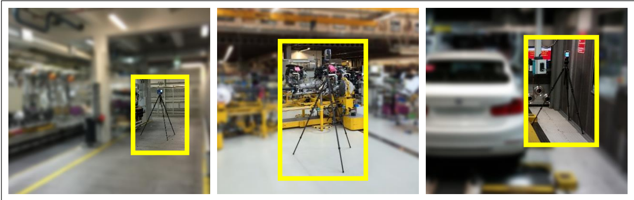
Abbildung 6-5: Beispiel eines eingesetzten 3D-Laserscanners; Scanner gelb eingerahmt (bei verschiedenen Projekten)
