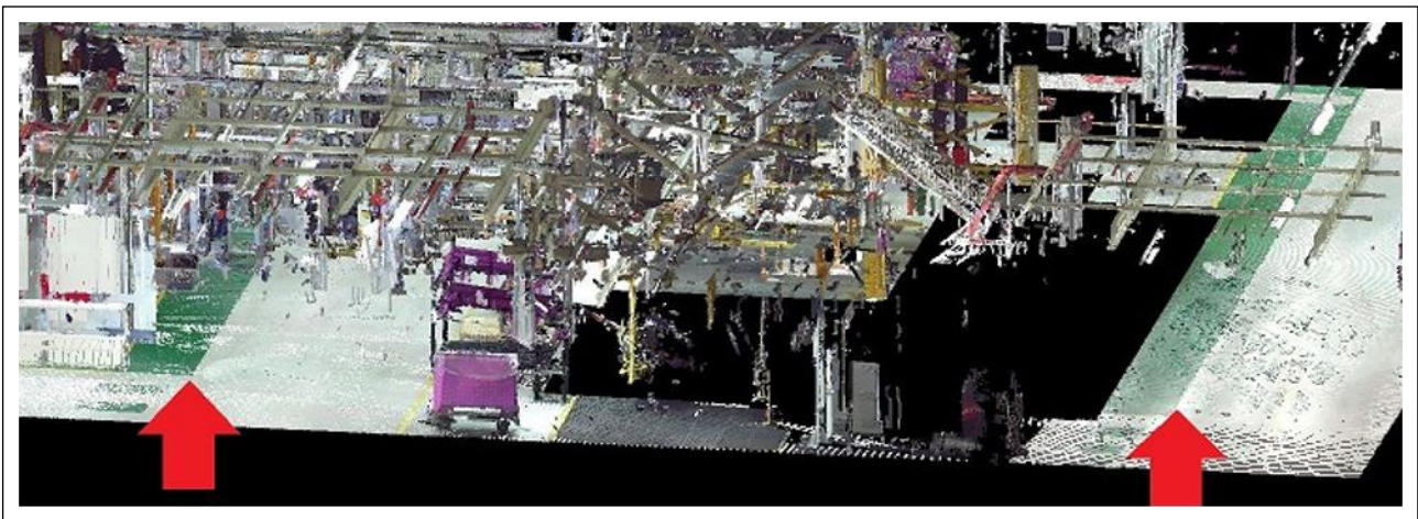
Abbildung 6-16: Fehlerhafte Registrierung zweier Punktwolken. Die grün gefärbten Bereiche sind Wegeflächen, die übereinstimmen müssten.
