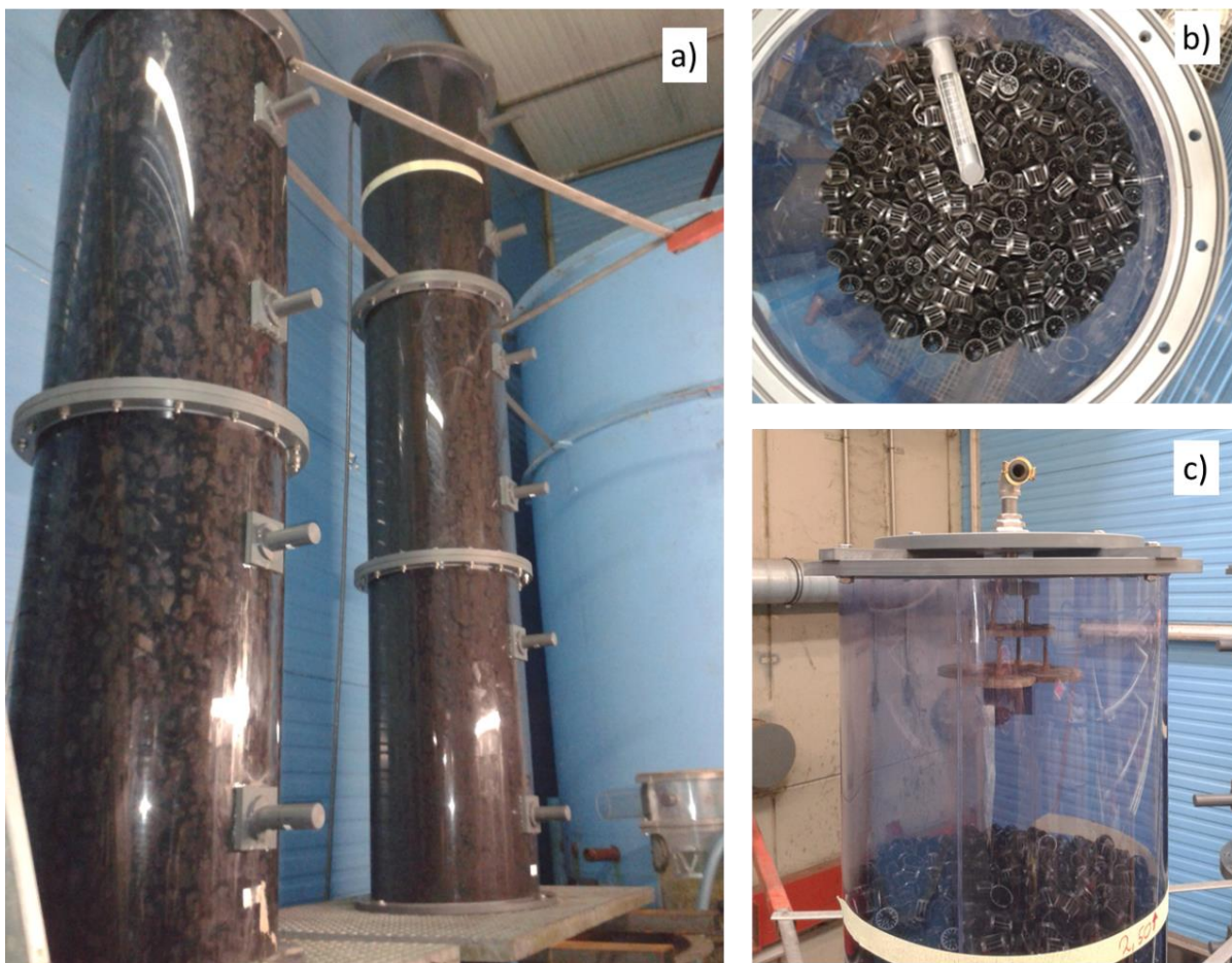
Abbildung 18: Halbtechnische Tropfkörper in der Klimakammer des ISWA (a)); Draufsicht auf das Füllmaterial und eine Probenahmestelle im Füllmaterial (b)); Prallteller zur Abwasserverteilung auf den Tropfkörpern (c)
