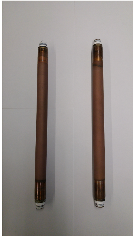
Kupfer hydrophob plasma-beschichtet
