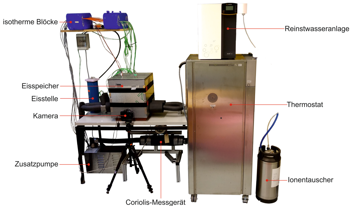
Abbildung 4-2: Aufbau des Versuchsstandes
