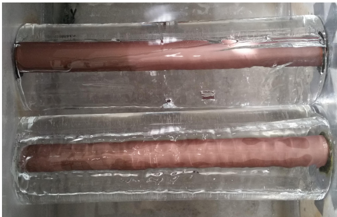
Abbildung 3-21: zylinderförmiger Eismantel um Wärmeübertragerrohre
