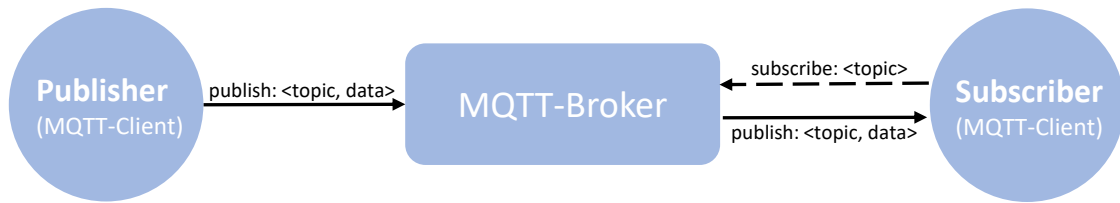
Abbildung 2.1.: Funktionsweise des MQTT
