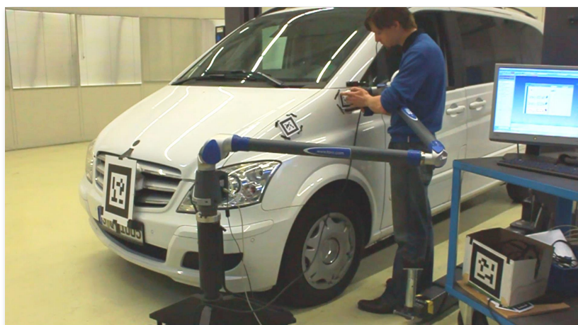
Bild 7.10: Taktiles Vermessen der Marker am Fahrzeug
