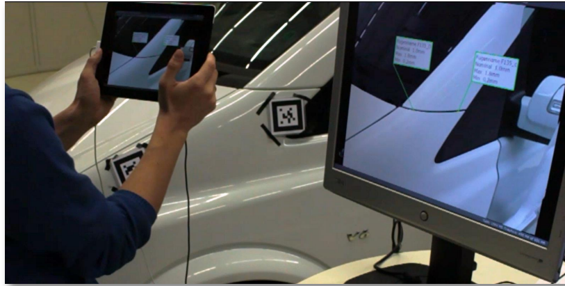
Bild 7.9: Darstellung der Toleranzwerte an zwei Messstellen als Flags auf iPad und Bildschirm
