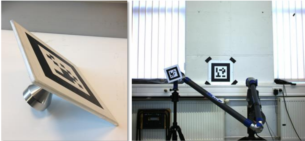
Bild 6.10: Versuchsaufbau Praxistest Markergenauigkeit
