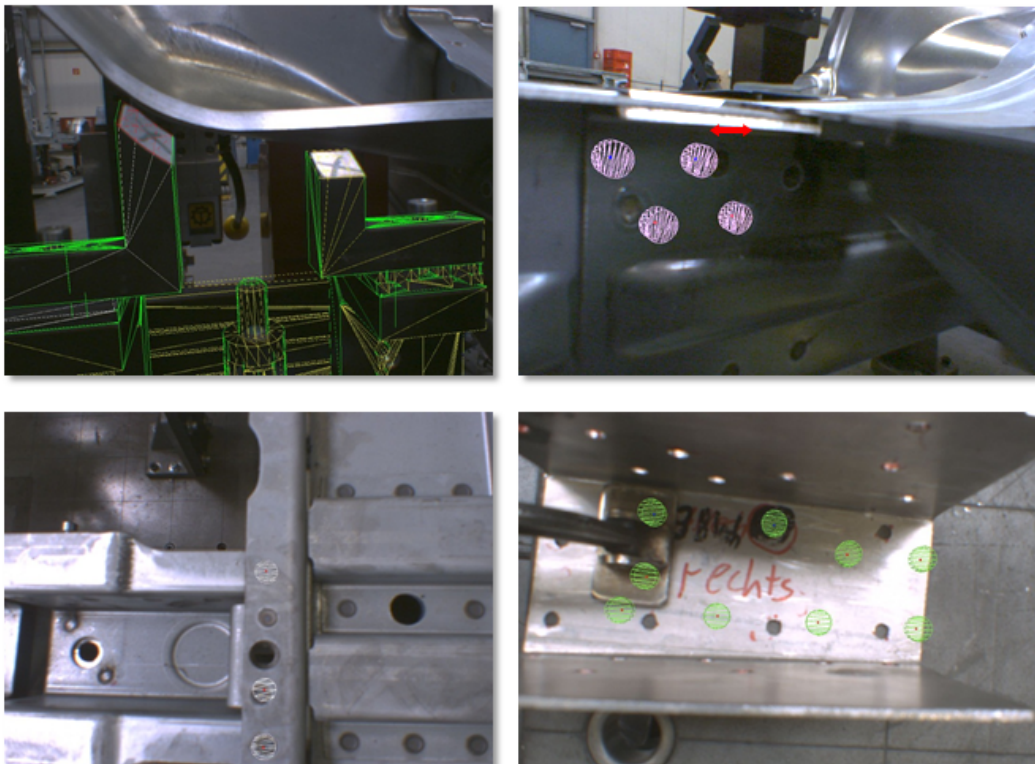
Bild 7.2: Ergebnisse der Schweißpunktuntersuchung mit Mixed Reality: Soll-Ist-Abgleich der Aufnahmevorrichtung (oben links), spiegelbildlich verwendete Schablone (oben rechts), fehlerhafte Schweißpunktposition (unten links) und fehlerhafte Schweißschablone (unten rechts)
