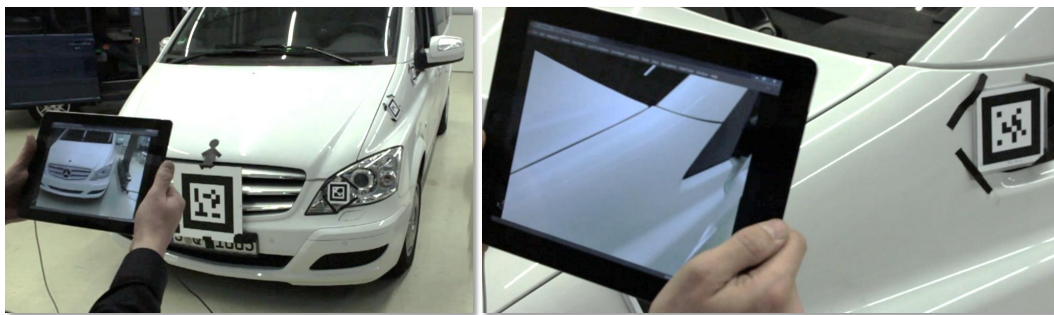
Bild 7.8: Beurteilung des digitalen Fugenkonzepts mit realistischer MR am Tabletcomputer
