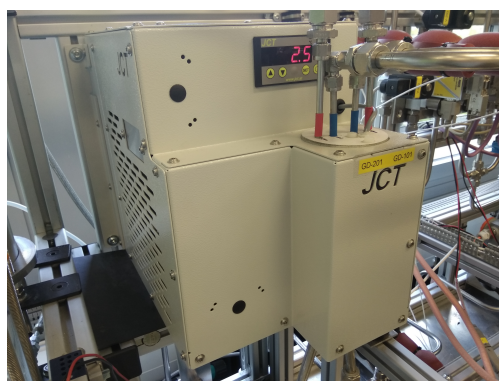
(d) Gas dryer
