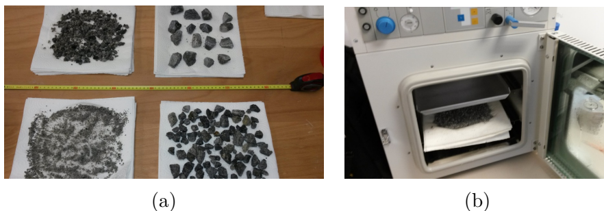
Abbildung D.5: Trocknung von Proben am Beispiel Kupferkies. Jeweils 3 Lagen Zellstofftücher (a) und 10 min bei 105 °C (b)
