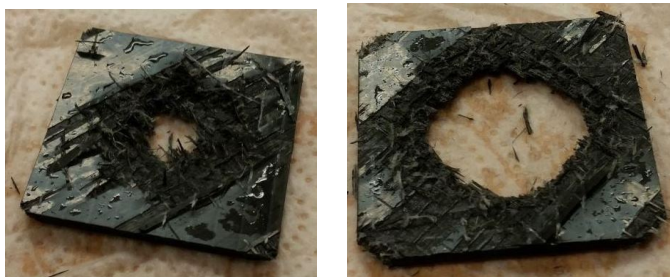
Abbildung 5.21: CFK Probenstück mit einer Grundfläche von 59 \times 59 \text{ mm}^2 . EDF mit 128 (links) und 512 Pulsen (rechts) bei U=130 \text{ kV}
