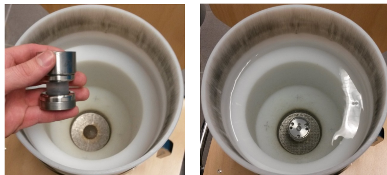
Abbildung H.2: Das Mikrogefäß wird innerhalb des Prozessgefäßes betrieben
