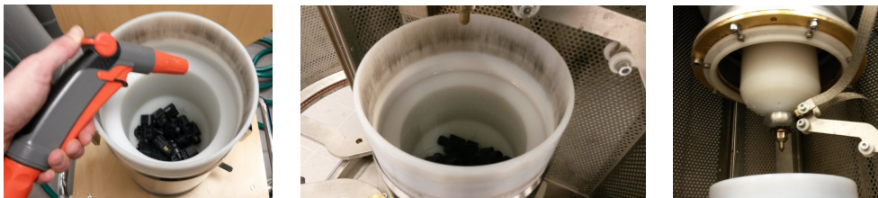
Abbildung D.3: PG wird mit Probenmaterial und Wasser befüllt und in SelFrag-Anlage positioniert
