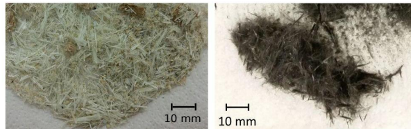
Abbildung 5.20: Glasfasern (links) und Carbonfasern (rechts) nach einer EDF von GFK und CFK
