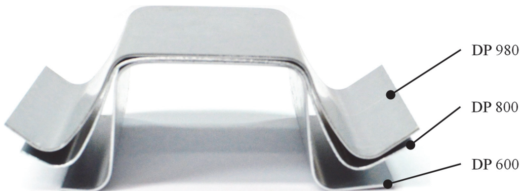
Abbildung 2-2: Vergleich der Rückfederung nach dem Umformen eines Hutprofils aus den Stahlblechwerkstoffen DP 600, DP 800 und DP 980; Blechdicke s_0=1,0 mm; Blechhalterkraft in jedem Fall F_{BH}=300 kN
