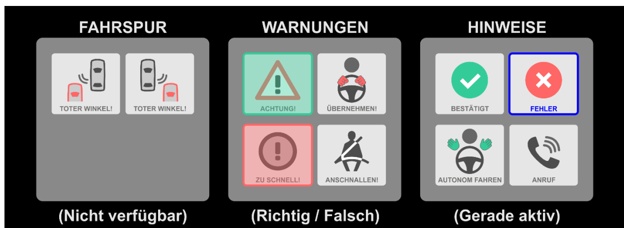
Abbildung 8.2: Feedback-Konzept bei der Probandeneingabe in V3 (exemplarisch)
