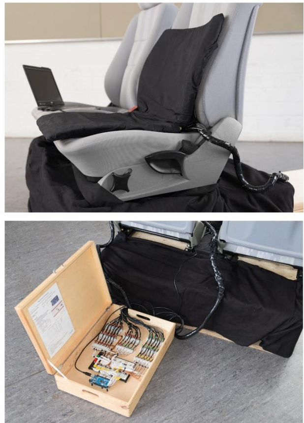
Abbildung 5.2: Schematischer Aufbau der TSM (Maße in mm) und Realisierung (Sitzauflage / Elektronik)
