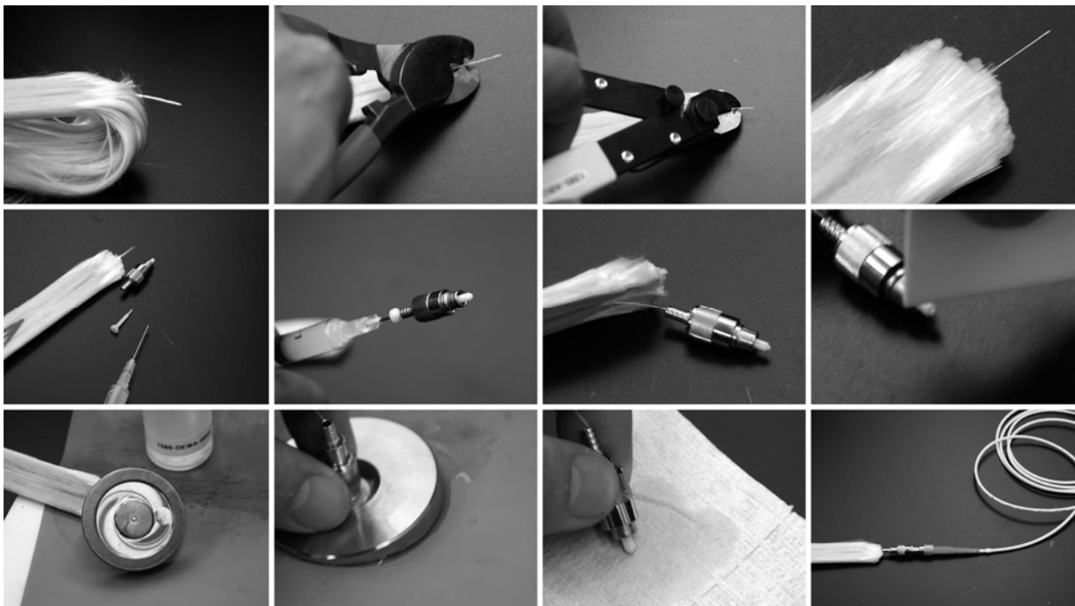
Abbildung E-14: Arbeitsschritte für die Kontaktierung einer losen Sensorfaser, von links nach rechts
