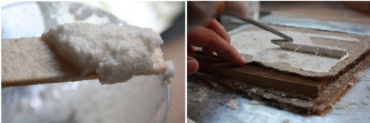
Abbildung B-6: Verkapselter Latentwärmespeicher als Additiv für ein Harz, Studentenprojekt 12
