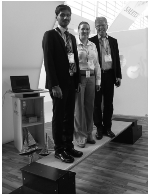
Abbildung E-18: Prototyp mit integrierten faseroptischen Sensoren, im Hintergrund: Messgerät mit Laptop zur Echtzeitmessung der Wellenlängenverschiebungen während der Belastung [Projekt]
