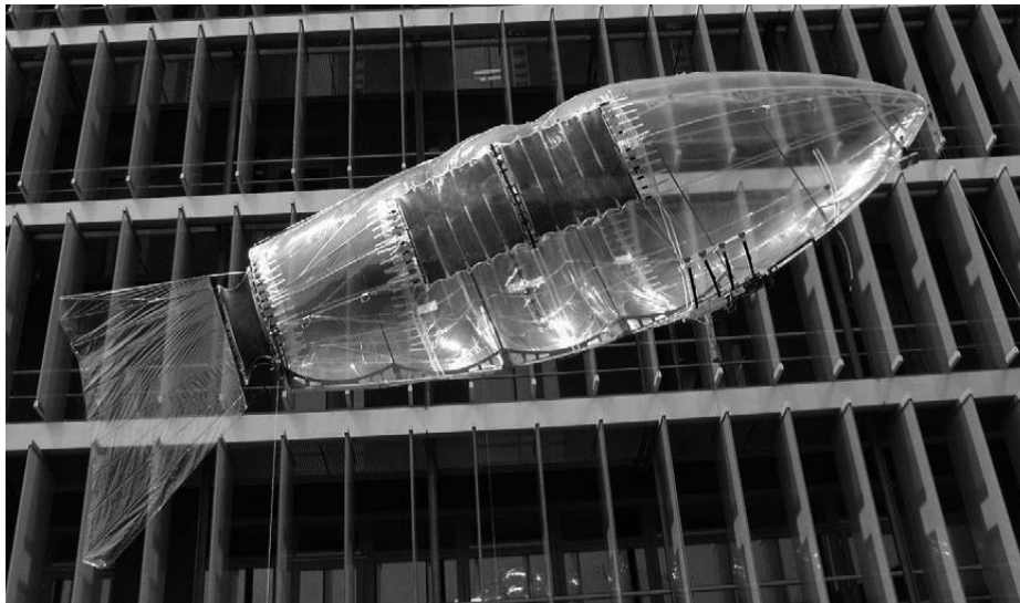
Abbildung B-19: Verwendung dielektrischer Polymere für den Antrieb eines kleinformatigen Prallluftschiffs [Jor10]
