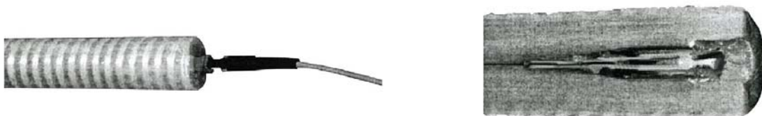
Abbildung E-15 Im Fertigungsprozess eines Rundstabs mit 22 mm Durchmesser eingebetteter vorkonfektionierter Stecker [Fra01]
