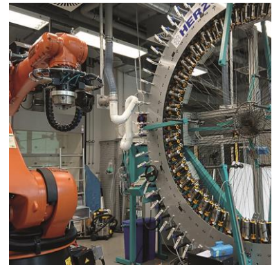
Bild 73: Roboter und Flechtrad (d ~ 4 m) der DITF Denkendorf
