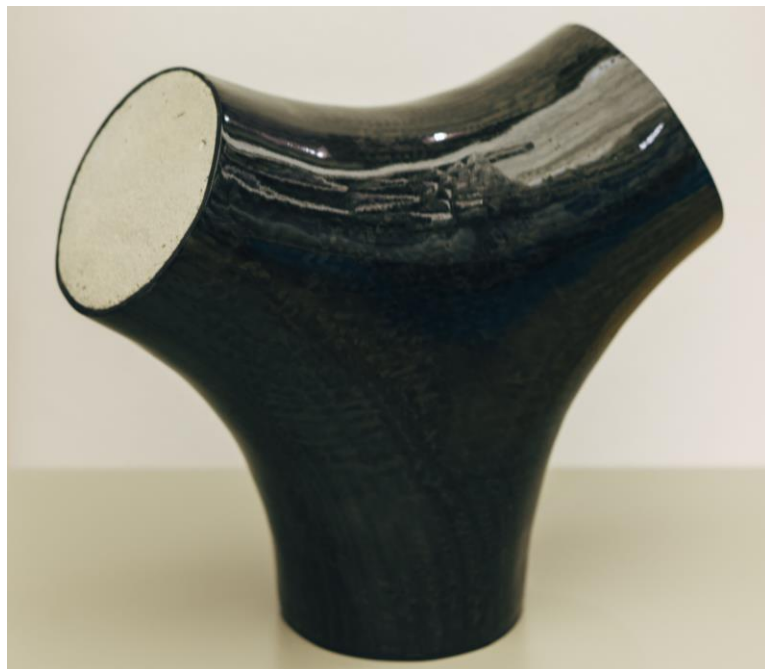
Bild 84: Hybrider Tragknoten mit drei Schenkeln, in Kooperation mit dem ITFT hergestellter Funktionsdemonstrator mit nachbehandelter, geschliffener Oberfläche in der Ausstellung „Baubionik“, Naturkundemuseum Stuttgart
