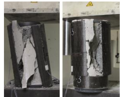
Bild 102: VR1: Probe B2 und Probe W3 nach dem Belastungsversuch mit aufge-rissenen Umschnürungen
