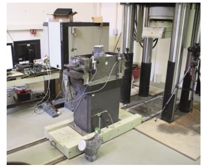
Bild 131: VR3: Setup Druck und Biegeversuche
