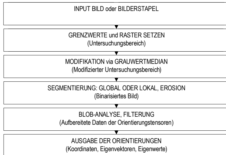
Bild 23: Ablauf des Programms zur Analyse von Faserorientierungen, Schritt „Orientierungstensoranalyse“ in Bild 20
