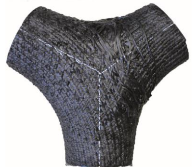
C: Imprägnierte CF-EP-Hülle
