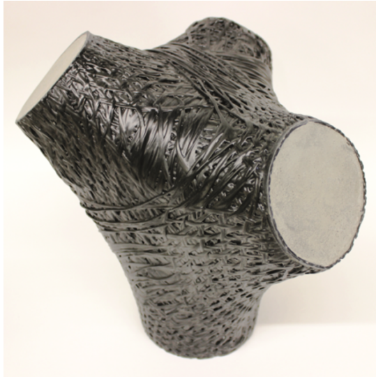
Bild 150: Vierschenkliges Hybrid-Tragknoten aus FKV (CF-EP) und Beton, Prototyp hergestellt am ITFT, Bild: Larissa Born, ITFT, Universität Stuttgart
