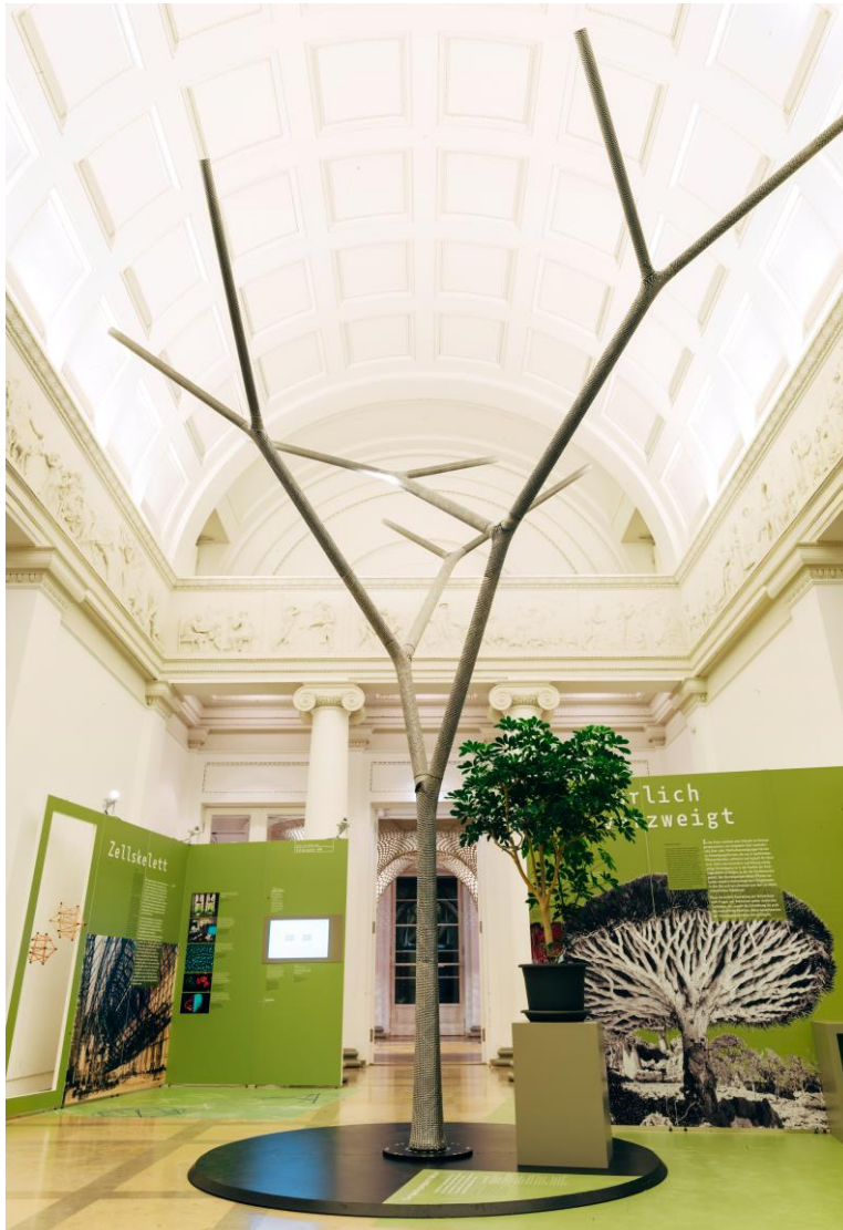
Bild 54: Verzweigte Tragstruktur mit triaxial geflochtenem Textil, Ausstellung „Baubionik“ im Schloss Rosenstein (PBG, ITKE, ITFT)
