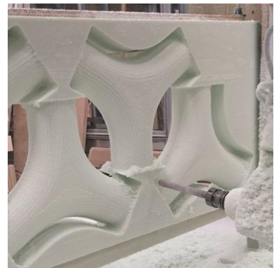
A: Fräsen von Formteilen
