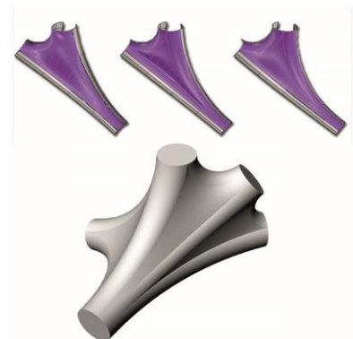
Bild 86: Mehrfachverzweigung mit konkaven und für die Flechtanlage verbesserten Flächen
