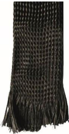
Bild 76: Zweiflechtiges (biaxiales) Schlauchtextil aus Carbon-Rovings
