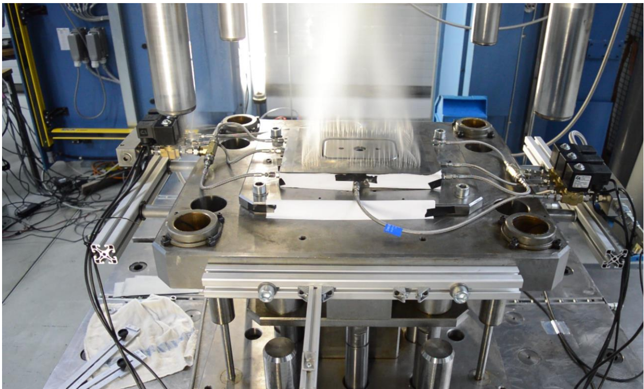
Abbildung 8-10: Werkzeugunterteil mit Blechhalter (a) vor dem Tiefziehprozess mit eingelegter Platine und (b) frei ausströmendem CO 2
