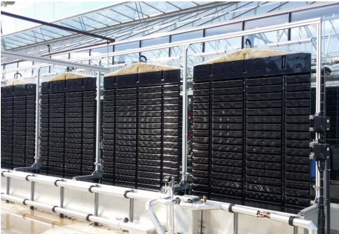
Abbildung 12: FPA-Reaktoren (180 L) zur Produktion von P. tricornutum Biomasse in der Pilotanlage des Fraunhofer-Zentrums für Chemisch-Biotechnologische Prozesse CBP, Leuna (2015) im Freiland und Gewächshaus. Im Rahmen dieser Arbeit wurden etwa 30 kg P. tricornutum -Biomasse erzeugt um die Aufarbeitung der Biomasse im Hinblick auf die Wertstoffe Fucoxanthin und EPA zu untersuchen.
