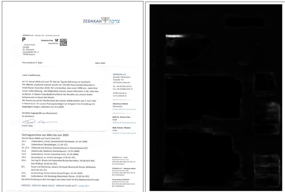
Abbildung 1.2.: Links das Originaldokument, bei dem die Absenderadresse erkannt werden soll. Rechts die Vorhersage einer künstlichen Intelligenz, die auf das Erkennen der Absenderzeile trainiert wurde. Je heller der Bereich in der Wahrscheinlichkeitskarte, desto höher die vorhergesagte Wahrscheinlichkeit.
