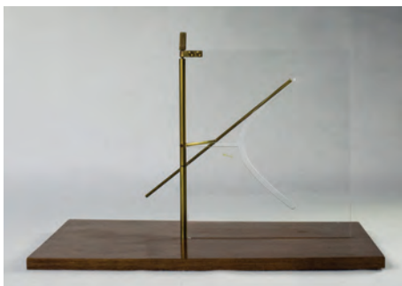
Erzeugung eines einschaligen Rotationshyperboloides durch Rotation einer zur Achse windschiefen Gerade
