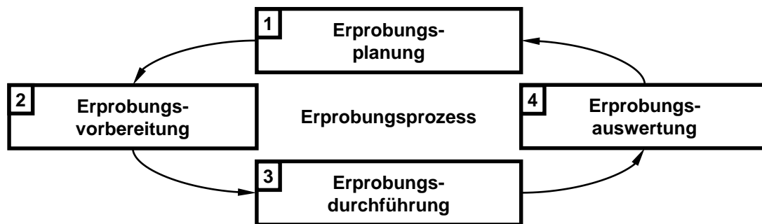
Bild 3.4: Erprobungsprozess in Anlehnung an Zeller und Sonntag [ZELLER90, S. 517]
