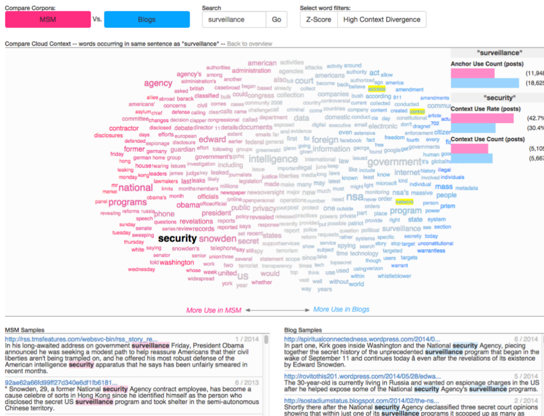
Abbildung 3.2: Visualisierung in Compare Clouds, die für das Wort „surveillance“ die Unterschiede in der Verwendung zwischen Mainstream-Medien und Blogs zeigt [DES+15]
