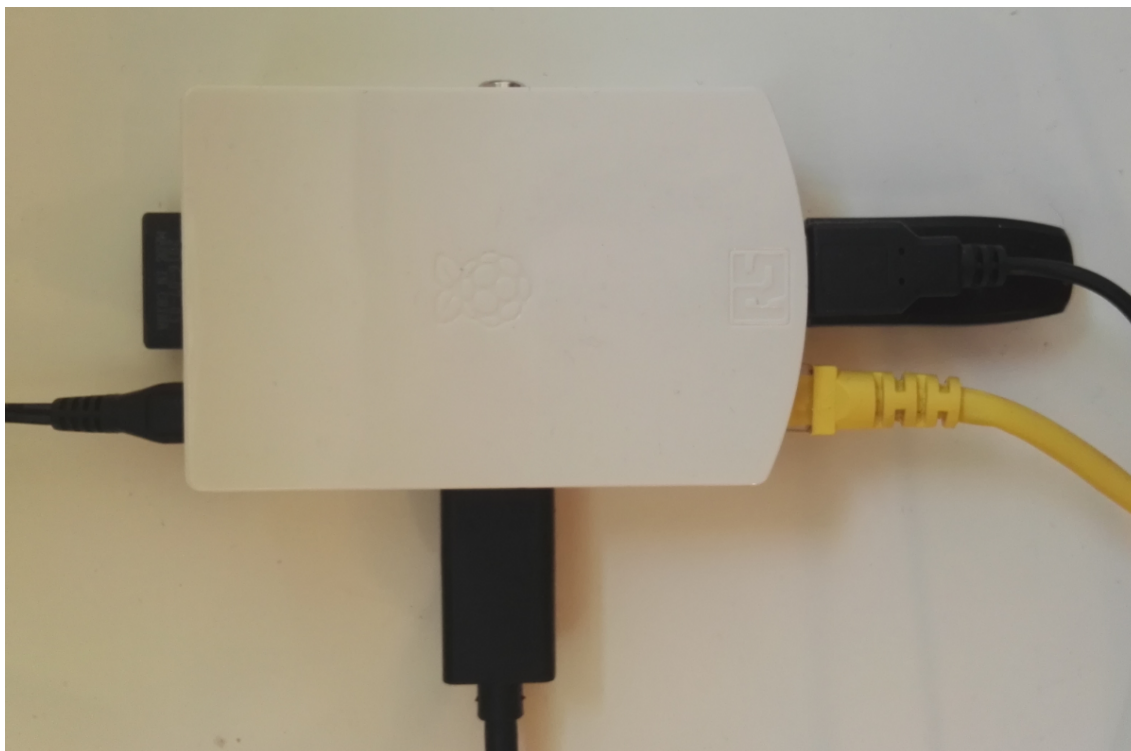
Abb. 5.5: Der verwendete Raspberry Pi. Links der Stromanschluss und die SD-Karte mit dem Betriebssystem, unten der HDMI-Anschluss zum Bildschirm. Rechts der USB-Stick, der die Datenbank speichert und die Verbindung zu einem USB-Hub, um Maus und Tastatur anschließen zu können.
