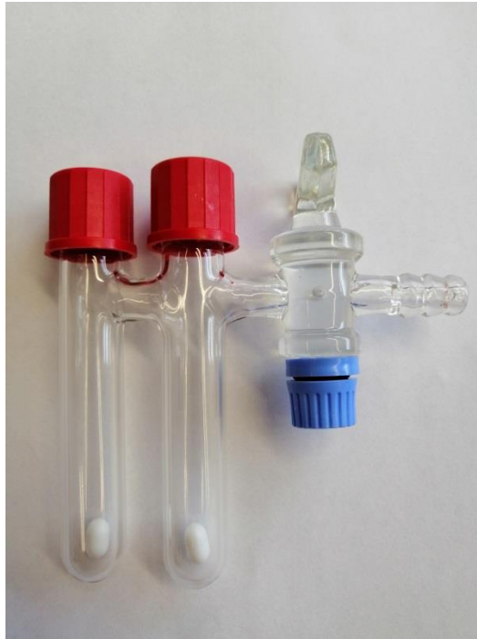
Abbildung 12: Doppelrohrschlenk zur getrennten Reaktionsführung.
