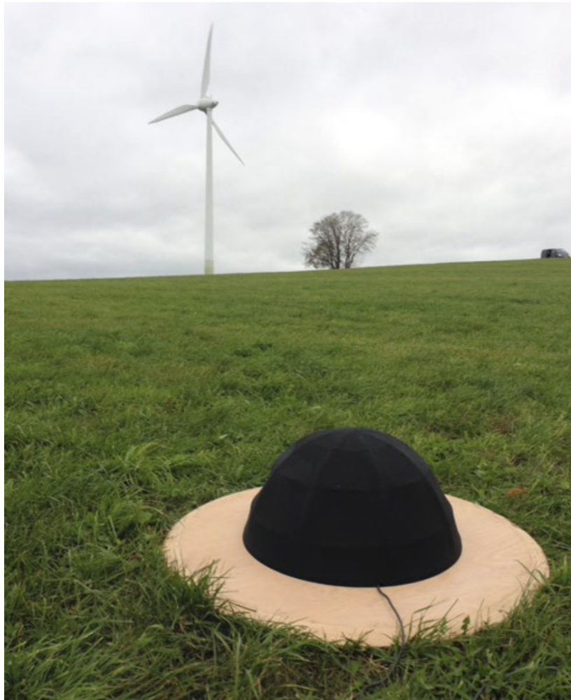
Abbildung 2.8.: Beispiel einer schallharten Platte und doppeltem Windschirm um das Mikrofon zur Messung von WEA-Schallemissionen. Foto aus [34]
