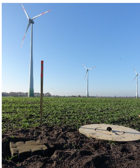
Abbildung 1: Schallmessung an einer Windenergieanlage
