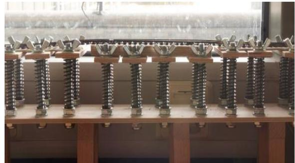
Abbildung 17: Steifigkeitswechsel am Brückenanfang und-ende im Modell [24]
