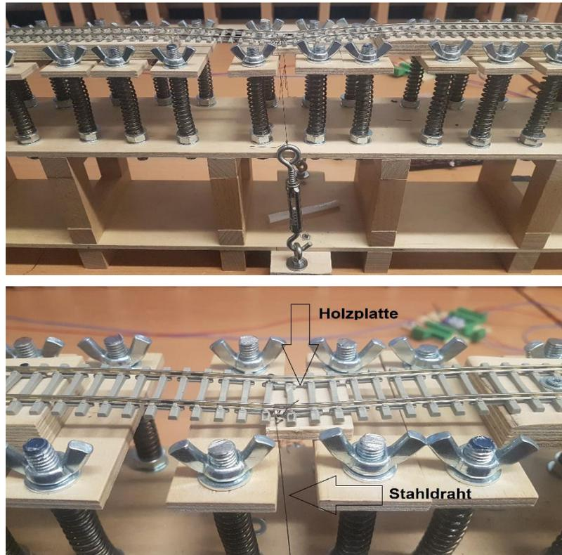
Abbildung 89: Längshöhenfehler mit Holzplatte im Modell
