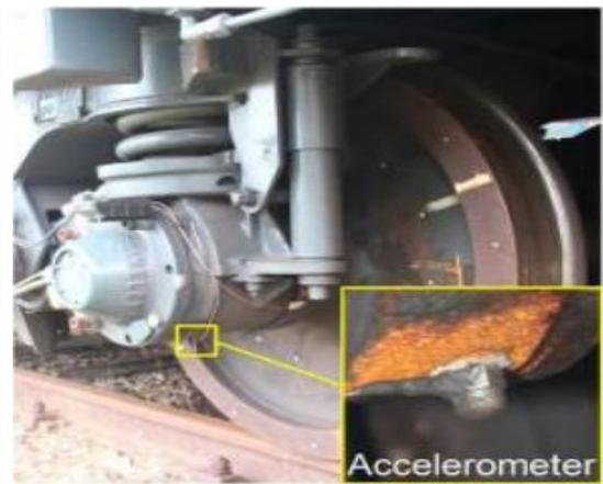
Abbildung 4: Beschleunigungssensor am Achslager [11]
