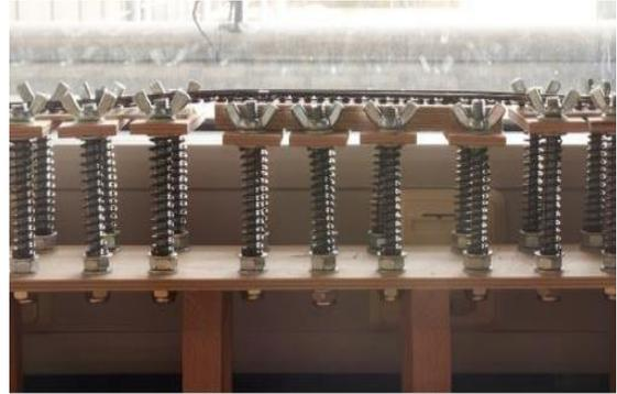
Abbildung 24: Steifigkeitswechsel am Brückenanfang und-ende im Modell [24]
