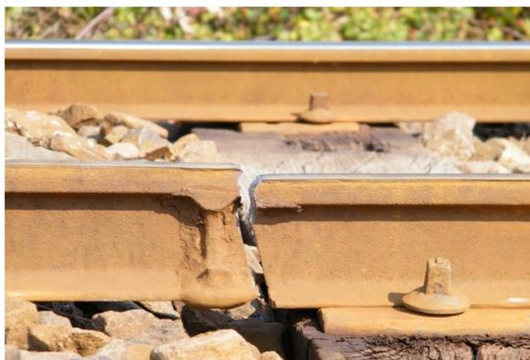
Abbildung 12: Schienenbruch im Real System [23]
