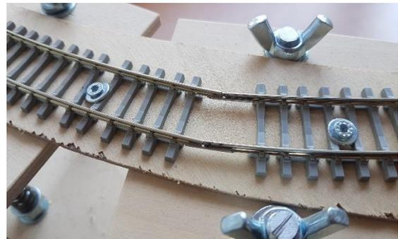
Abbildung 11: Schienenstoß im Modell
