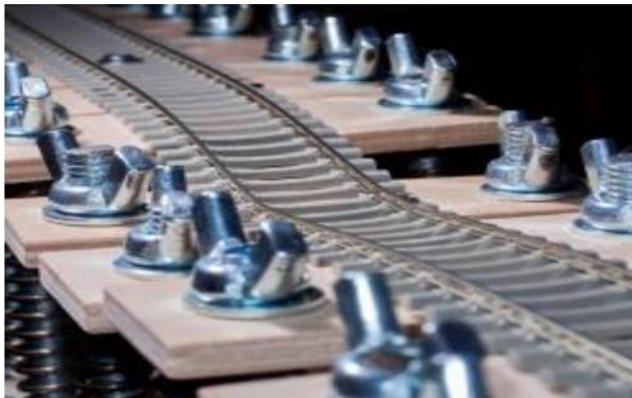
Abbildung 25: Punktueller Instabilität im Modell [24]
