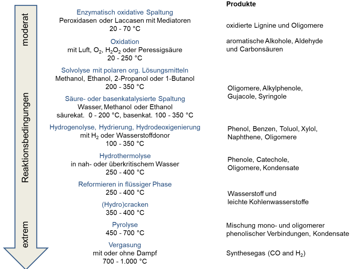
Abbildung 23: Einteilung der Konversionsverfahren für Lignin anhand der Intensität der Reaktionsbedingungen und der erzielbaren Produkte, Daten aus [192–199]
