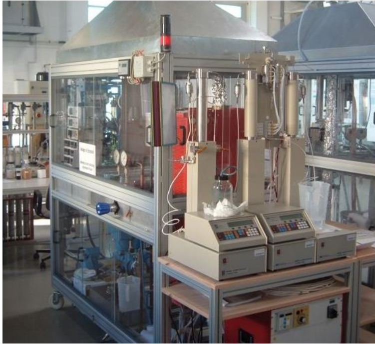
Abbildung 81: Foto der Versuchsanlage zur Hydrothermolysen von Lignin
