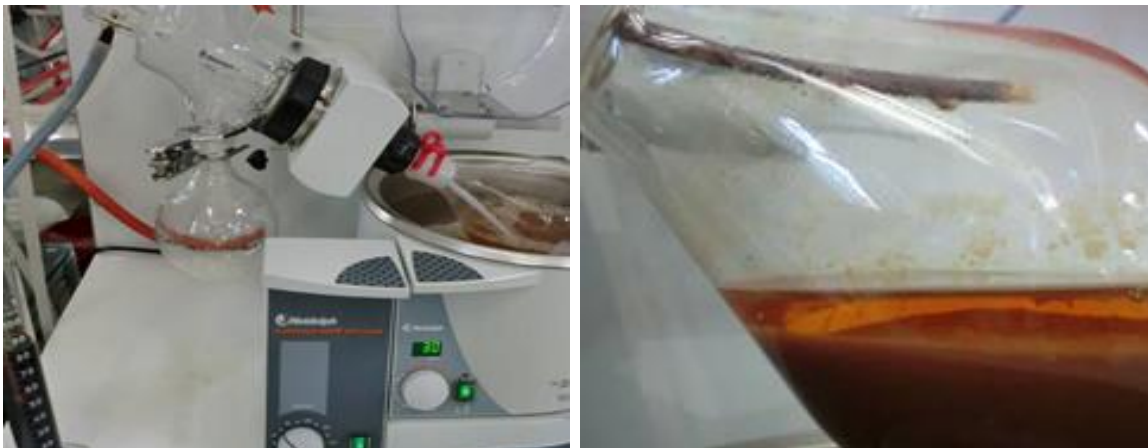
Abbildung 66: Versuchsaufbau zur kontinuierlichen Verdampfungsfällung (links) und erhaltenes Sumpfprodukt (rechts)
