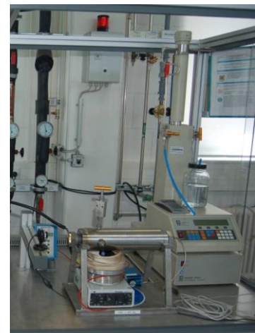
Abbildung 82: Schematischer Aufbau der Hochdrucksichtzelle inklusive Peripherie und Foto des Versuchsaufbaus
