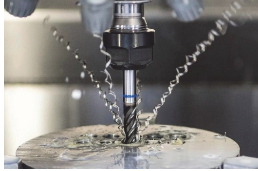
Abbildung 2: Technisches Problem langer Wirrspäne am Beispiel der Gewindebohrbearbeitung ( Bild: Hoffmann Group )
