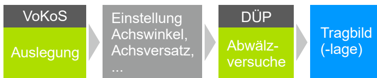
Bild 7.1: Grundsätzliche Vorgehensweise für die Versuche
